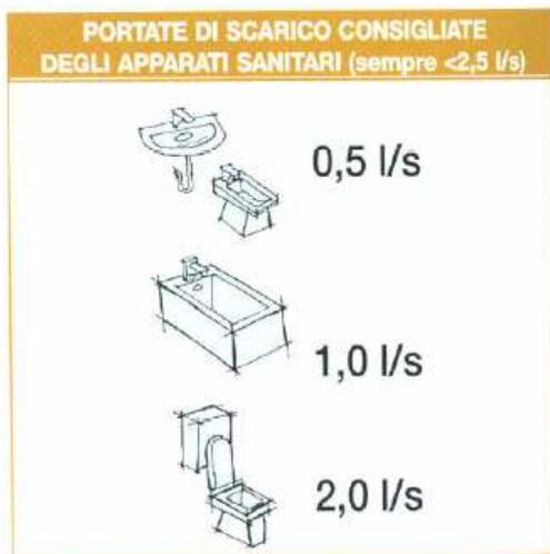
Figura 5.68 – Indicazione delle portate di scarico consigliate degli apparati di scarico
