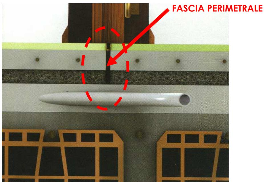
Figura 6.13 – Posizionamento della fascia perimetrale che si consiglia di adottare in corrispondenza delle porte
